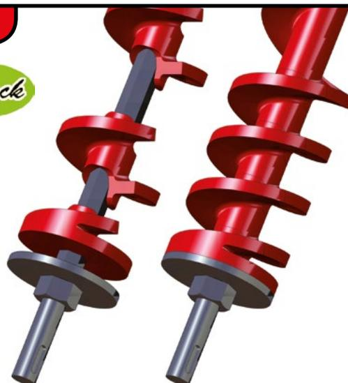
Lorsque la vis est usée, vous ne remplacez que les modules en plastique; vous conservez l'axe et ses usinages d'extrémités. Les modules peuvent être usinés pour en réduire le diamètre, vous permettant ainsi de remplacer facilement une vis existante.
